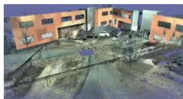
cadwork conception kann Punktwolken (Dateien mit mehreren Millionen Punkte) aus Laserscannern einlesen. Legen Sie Schnitte in die Wolke und lassen Sie Knoten auf die Punkte im Schnitt rechnen. Diese können dann ins cadwork 3D/2D übernommen werden.
